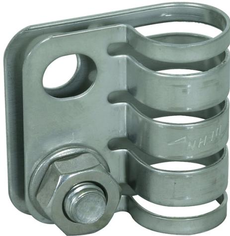
CONEXÃO AÇO INOX PARA CONDUTOR HVI Para descarregar o campo elétrico do condutor longo HVI na faixa final de vedação. Construído com fenda especial para contato elétrico com revestimento semicondutor.
