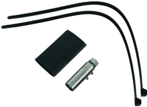
CONEXÃO PARA CONDUTOR HVI Elemento de conexão para vedação do condutor longo HVI. Para fixar a extremidade da vedação do condutor no lado externo do tubo de suporte (cabeçote para placa de conexão). Incluso uma manga termoretrátil e duas abraçadeiras.
