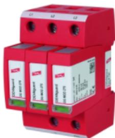
DGMTNC275FM Protetores de surto modulares para utilização em sistemas TN-C (configuração 3 + 0). Constituídos por uma peça de base e um módulo de proteção plug-in contém alta capacidade de descarga devido ao resistente varistor de óxido de zinco, devido ao sistema "Thermo Dynamic Control" possui alta confiabilidade na utilização. A substituição dos módulos é fácil devido ao sistema de bloqueio do módulo com o botão de liberação do módulo. Vibração e teste de choque de acordo com EN 60068-2.
