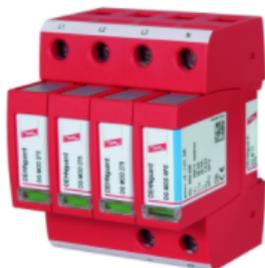
DGMTT Protetores de surto modulares para utilização em sistemas TT e TN-S (configuração 3 + 1). Constituídos por uma peça de base e um módulo de proteção plug-in. Contém alta capacidade de descarga devido ao resistente varistor de óxido de zinco, devido ao sistema "Thermo Dynamic Control" possui alta confiabilidade na utilização. A substituição dos módulos é fácil devido ao sistema de bloqueio do módulo com o botão de liberação do módulo. Vibração e teste de choque de acordo com EN 60068-2.
