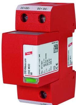
DSEM1242 DPS 100% centelhador com módulo de proteção plug-in. Tecnologia de centelhamento especialmente adequada para uso em circuitos D.C Possível coordenação com dispositivos de proteção contra surtos DEHNguard SE DC 60 (tecnologia com varistor)
