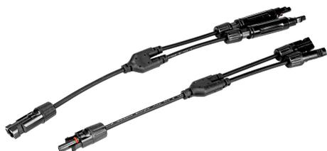
SC4-FY (Conexões em Paralelo) Utilização em sistemas fotovoltaicos; Para conexões elétricas em paralelo de dois arranjos/strings; Possui fusível integrado para proteção contra corrente reversa; Benefícios: Qualidade na instalação; Fácil conexão entre painéis; Melhor durabilidade a exposição climática (típicas de sistemas fotovoltaicos);
