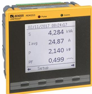
LINETRAXX - PEM353 A linha PEM353 são medidores universais utilizados para gravar e mostrar as medidas realizadas em um circuito de alimentação e possibilitar a comunicação entre os equipamentos. Permite realizar a medição em sistemas monofásico ou trifásicos, com sistemas TN, TT ou IT de aterramento. Monitora a qualidade da energia gerada, com inúmeros parâmetros Possui alarmes e configuração dos limites Realiza a medição e supervisão em condutores neutros Registra todas as medições realizadas
