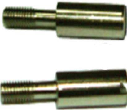
Constituído de elementos macho (guia) ou fêmea (bucha) evita o acoplamento incorreto dos contatos. Recomendado nas tomadas acima de 72 pólos para a simetria de conexão, isto é, os insertos devem estar plenamente alinhados para não entortar e danificar os contatos.
