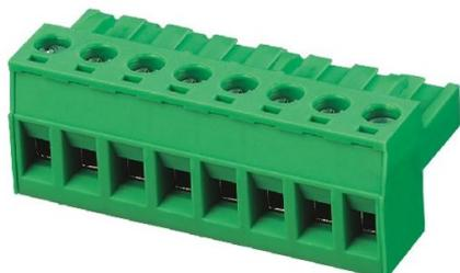
Os Conectores plugáveis da Série EDG são conhecidos por oferecerem uma grande vantagem na manutenção de placas eletrônicas, pois não é necessário a remoção de cabo por cabo, bastando apenas a remoção do plugue fêmea. Os conectores macho, também conhecidos por "HEADER", são fixados diretamente nas Placas de Circuito Impresso e estão disponíveis em diversos passos (ou Pitch). \*Modelos Disponíveis de 2P-22P polos. Caso não tenha na listagem de produtos, consultar nosso setor de vendas.
