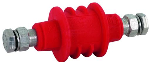
CENTELHADOR PARA JUNTAS DE ISOLAÇÃO Para conexão / aterramento indireto de partes funcionalmente isoladas de instalações sob condições de raios Dispositivo para ligação equipotencial de raio de acordo com IEC 62305 em áreas perigosas Para fazer a ponte de juntas de isolamento, flanges de isolamento, etc. em seções de tubo protegidas Catódicamente. Para instalação segura na zona Ex 1 (gás) ou 21 (poeira) Tensão
